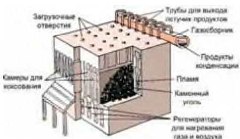
Рис. 3. Устройство коксовой печи
